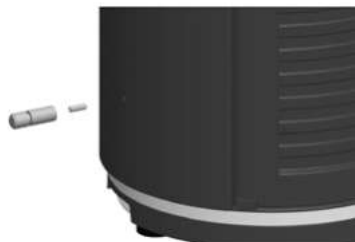
Obr. 2.8 Montáž držáků ochrany proti záření k zadní stěně dole (2 x)
