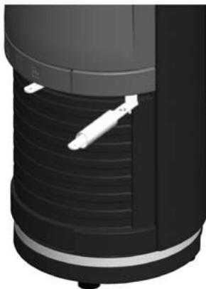
Obr. 3.2 Otevření dvířek topeniště
