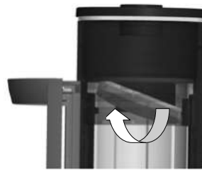
Obr. 3.17 Odebrání vodícího kamenu – kámen nejdříve zvedněte po straně a poté obloukem vyjměte.
