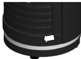
Obr. 3.3 Otevření dvířek popelníku zatažením za rukojeť dvířek
