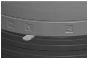
Obr. 3.10 Šoupátko spalovacího vzduchu: Poloha „Jmenovitý tepelný výkon“
