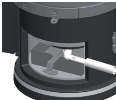
Obr. 3.5 Nářasný rošt s ovládáním ovládací rukojetí
