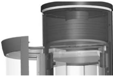
Obr. 3.16 Uspořádání vedení plynu v kamnech zobrazení v řezu
